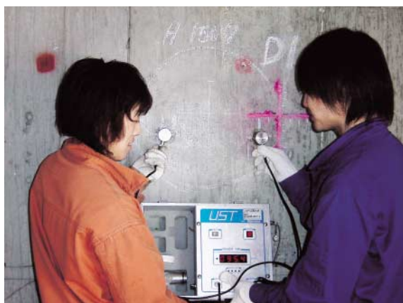
超音波伝播速度測定状況
