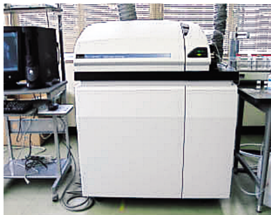
I C P 質量分析装置 ELAN DRC-e (Perkim Elmer社)
