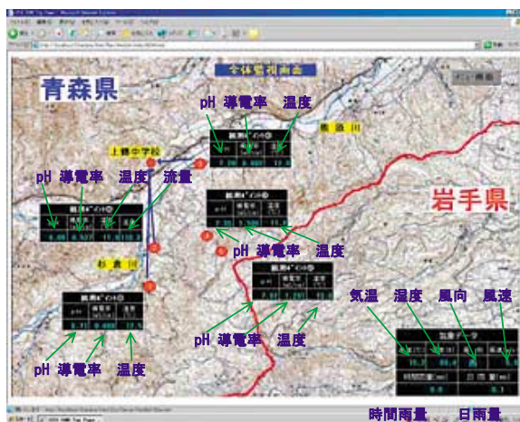
図2 設置センサーの監視画面
