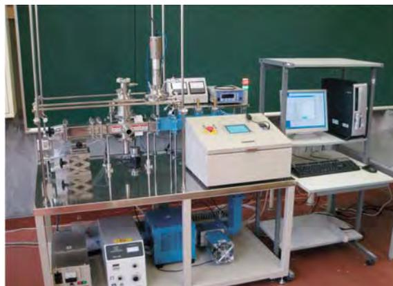
マイクロ波照射極限化学反応プロセスの流動発生解析装置
