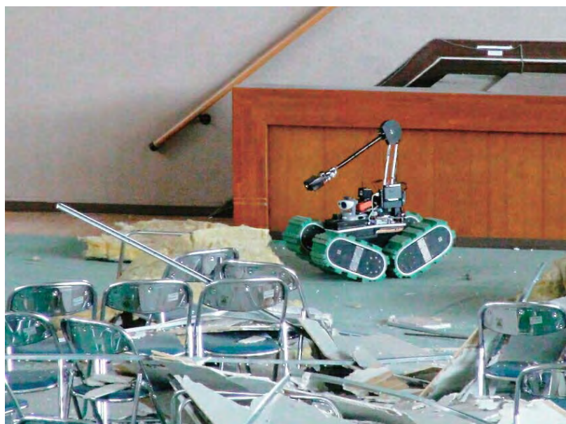
図1 KOHGA3を用いた被災状況の調査
