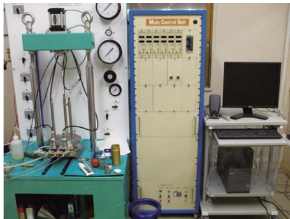
三軸圧縮試験装置
