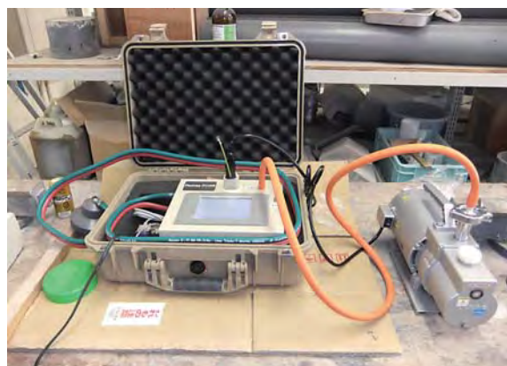
写真1 表層透気試験機
