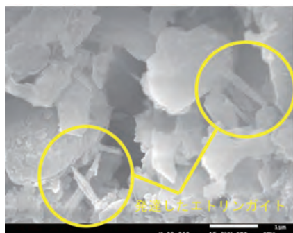
写真1 セメント固化したしらすの電子顕微鏡写真
