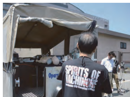
写真3 試作車2号。救急車のストレッチャーを手術台に使うことを想定した。
