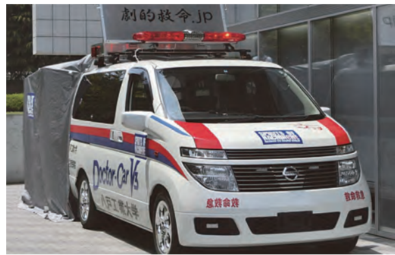
写真4 移動緊急手術室の手術室の TENT 部はベース車の天井に固定したボックスより引き出す蓋部の重量が約10kgあるが、特殊なヒンジを製作し、指1本で開閉できる構造とした。また、安全性と利便性を高めるため、任意の角度で固定できることとした。災害発生時にドローンの離発着が可能となるよう、完全フラット形状とした。
