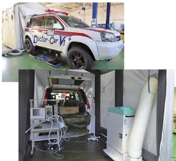
写真8 試作車4号は開発途中。 気密性のいいエアテントと、空気清浄器を備える。
