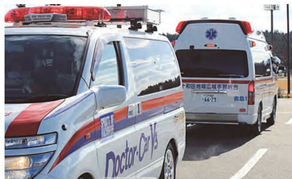
写真5 救急車とドクターカー V3 は、互いに尾部を向いて停車する。救急車からストレッチャーに乗せられた患者が直線的にドクターカー V3 の手術室に入室できる。
