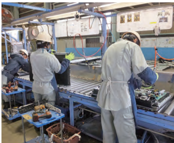
薄型テレビ解体作業
