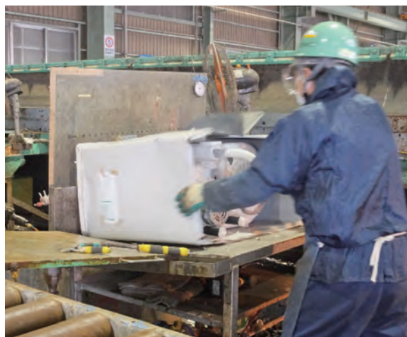
洗濯機解体作業
