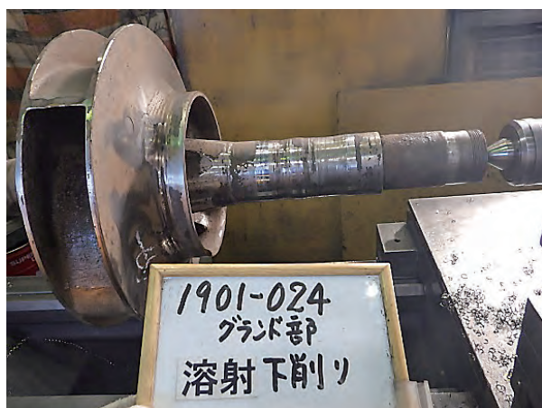
溶射による寸法再生（前）
