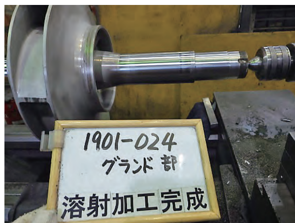
溶射による寸法再生（後）
